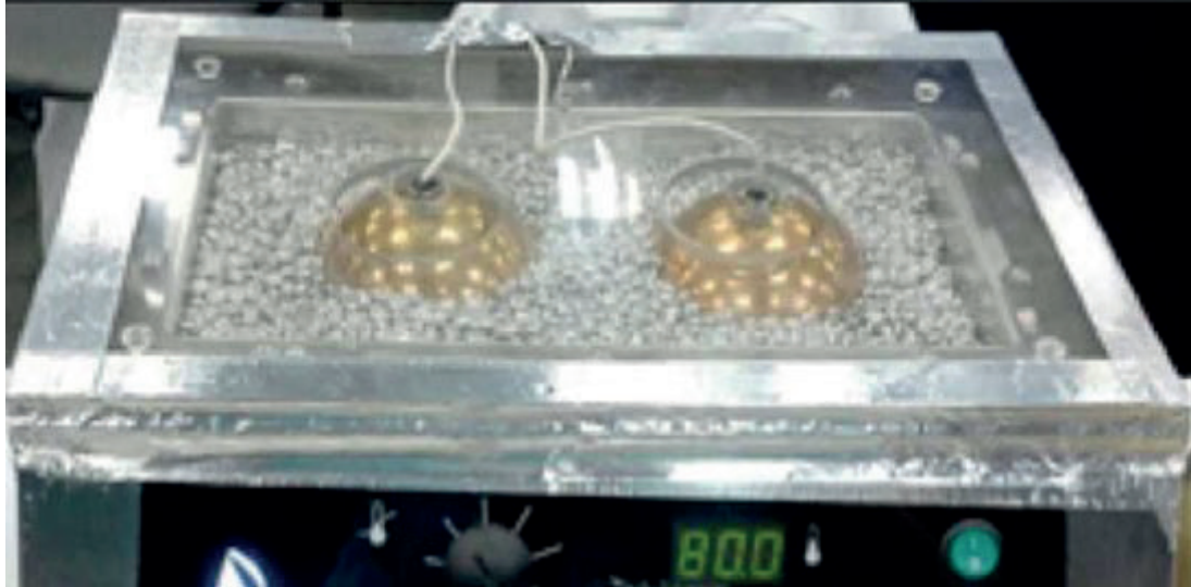
Фото 1. Золоті сфери, які випромінюють тепло протягом днів і місяців без підведення зовнішньої енергії (зразкова сфера зліва (84°C), контрольна сфера справа (79,6°C), алюмінієва місткість зі срібними намистинами (80,0°C).
